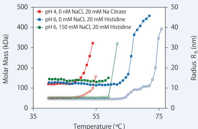
プレート内を徐々に加温しながら、連続測定を行うことで、多検体試料の温度安定性を短時間で測定できます。
