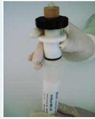
シールアダプタを取り外し。
