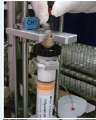
装置の配管(ルアーアダプタ)をカラムに接続します。
