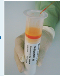
サンプルが徐々にカラム内フリット(フィルタ)に浸透していきます。
