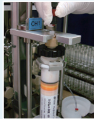
装置の配管(ルアーアダプタ)をカラムに接続します。
