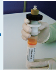
シールアダプタを取り付けます。
