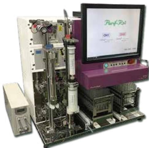
2ch パラレル型高中圧分取精製装置 Purif®-Rp2
