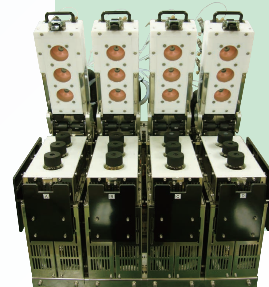
多検体高温反応槽 ( \sim 250^{\circ}\text{C} ) 小型ボンベガス類
