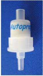
**PS@Liq:** 細孔分布を最適化した充填材を採用することで目詰まり問題を低減し、高速通液を可能とした固相抽出カートリッジです。環境水や土壌中の農薬のような有機物の迅速捕集に適しています。水道水中の農薬分析、チウラム、シマジン、チオベンカルブなどの応用例があります。
